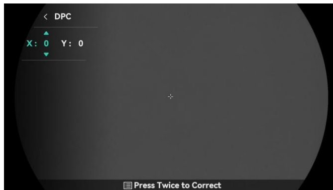
Figura 3-6 Corrección de píxeles defectuosos
